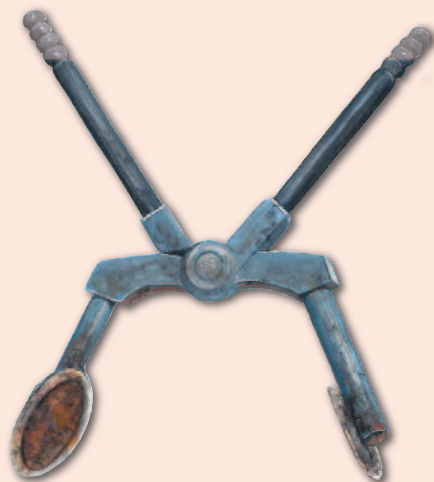
Une pince mal entretenue : à éviter
